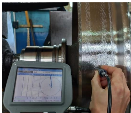
Рис. 5. Обнаружение подповерхностного дефекта в месте «остаточного рисунка» вихретоковым дефектоскопом ВДЗ-71
