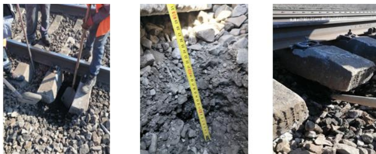
Рис. 1. Определение толщины и загрязненности балластного слоя
