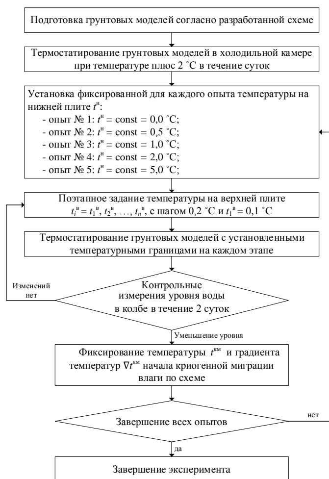
Рис. 5. Последовательность лабораторного эксперимента по определению температурных критериев начала интенсивного криогенного влагопереноса в грунтах
