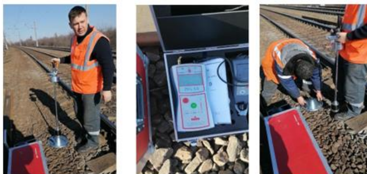
Рис. 6. Определение характеристики прочности и деформируемости балластного слоя
