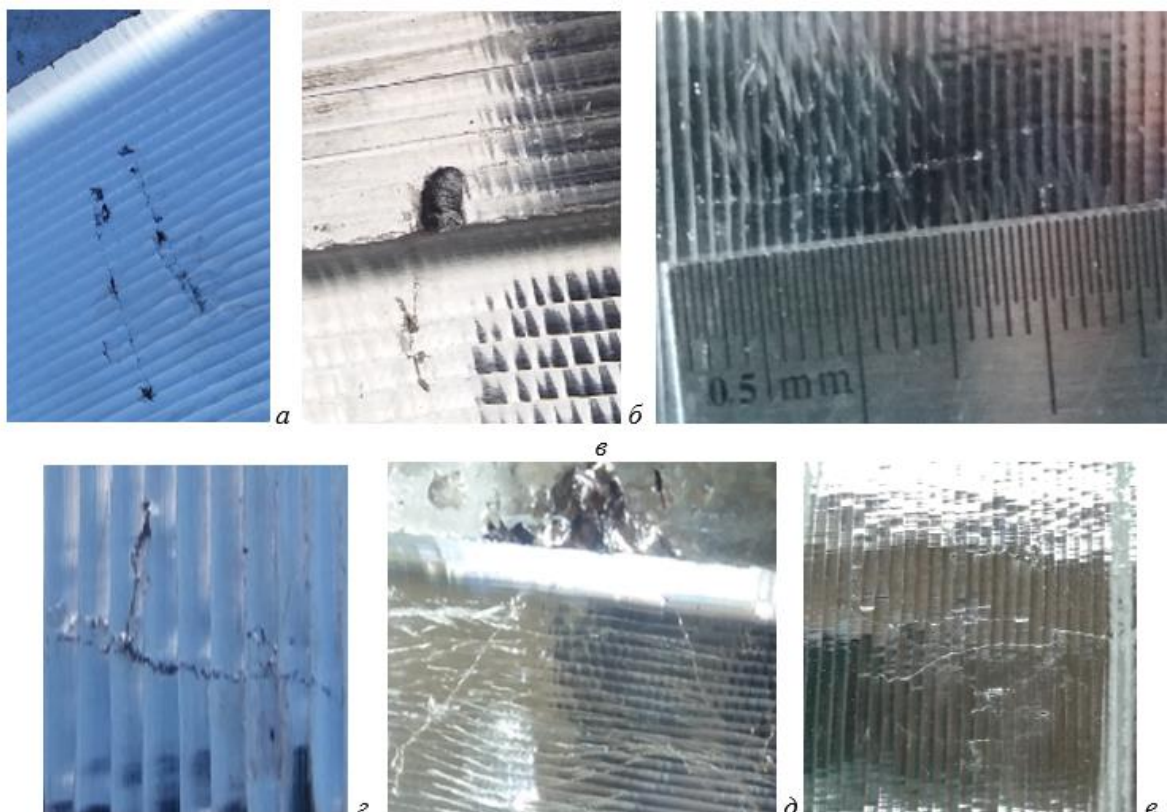
Рис. 1. Дефекты на поверхности катания после обточки колеса:
