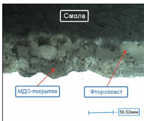
Рис. 1. Строение керамополимерных покрытий (увеличение \times 500 )
