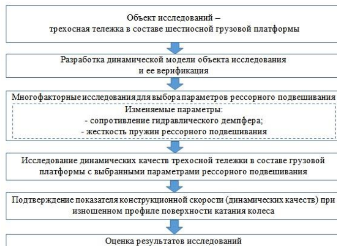
Рис. 5. Алгоритм проведения (иерархическая схема) исследований по выбору параметров рессорного подвешивания
