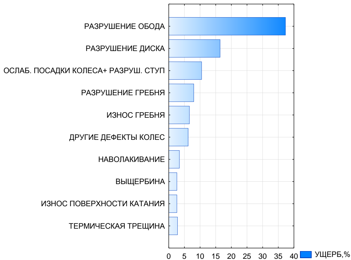
Рис. 2. Заявленный ущерб от дефектов колес, %
