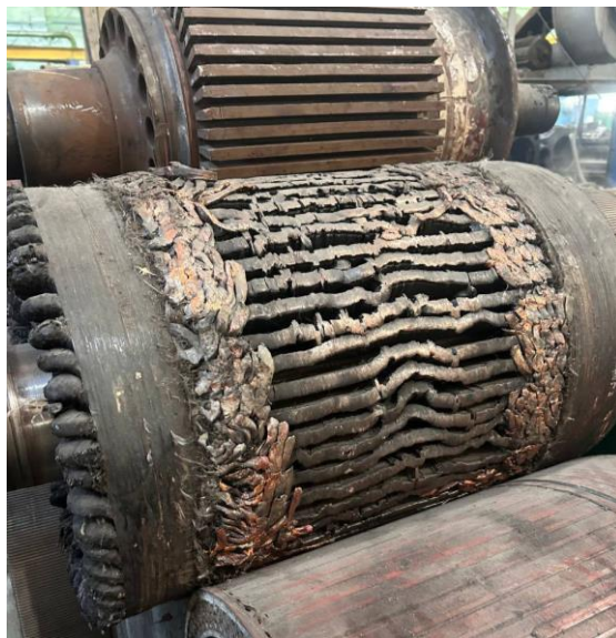
Рис. 1. Последствия действия кругового огня по коллектору тягового электродвигателя
