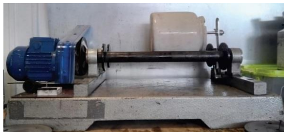
Рис. 4. Экспериментальная установка – барабанная мельница
