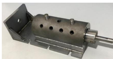
Рис. 1. Роторный модуль для гидроэксфолиации графита
