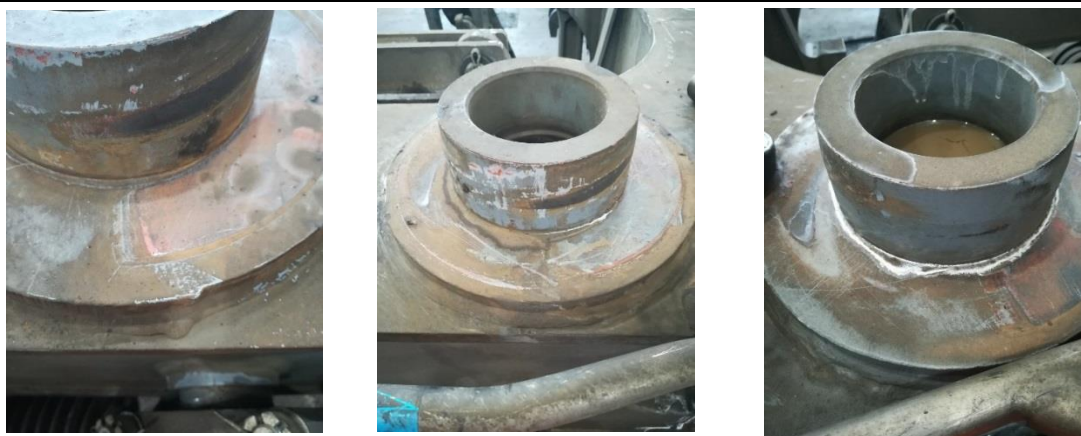
Рис. 1. Следы взаимодействия и смещения кузовной пружины на нижней чаше тележки
