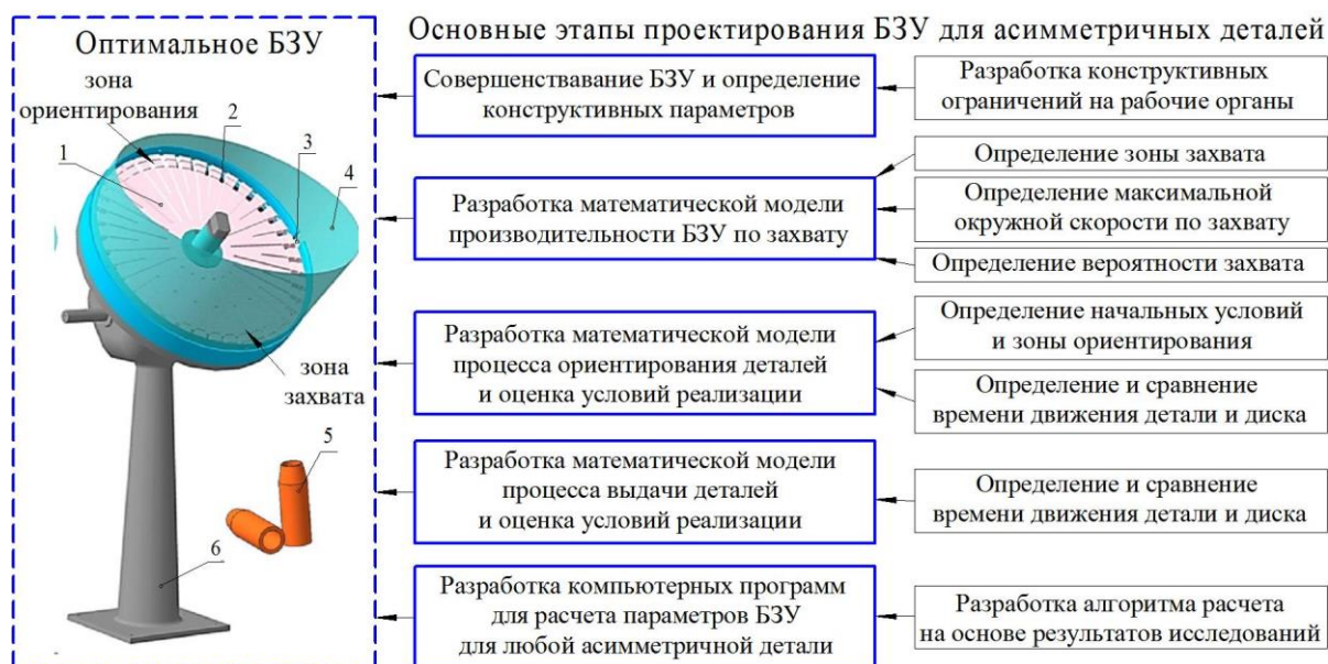
Рис. 1. Основные направления проектирования надежной конструкции механического дискового бункерного загрузочного устройства для асимметричных деталей формы тел вращения:
