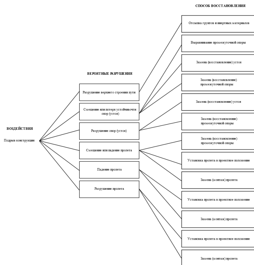
Рис. 6. Варианты сценариев при подарыве конструкций
