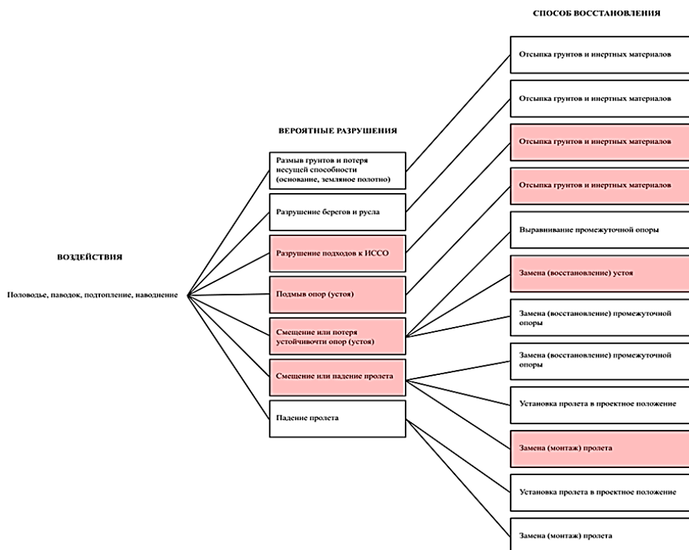
Рис. 7. Разрушения и способы их восстановления
