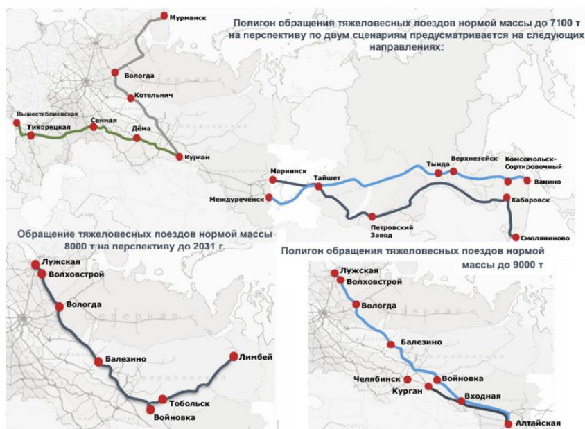
Рис. 3. Полигоны обращения тяжеловесных поездов весом 7100, 8000, 9000 т
