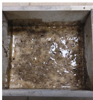
Рис. 2. Процесс формирования геокомпозита в металлической форме
