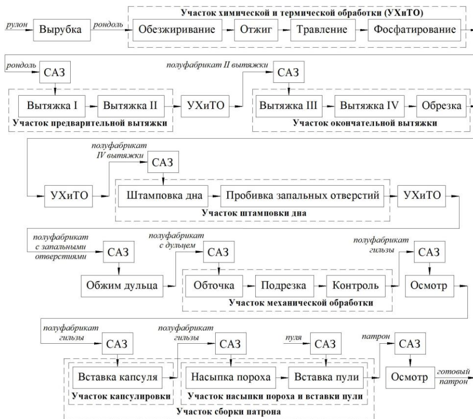
Рис. 1. Системы автоматической загрузки заготовок и готовых изделий в технологическое оборудование при изготовлении патронов
