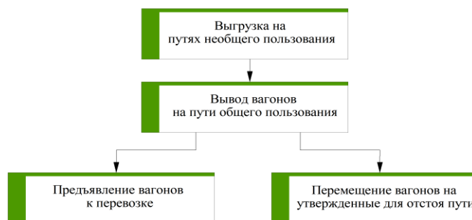
Рис. 3. Существующий порядок работы с порожними вагонами после завершения грузовых операций
