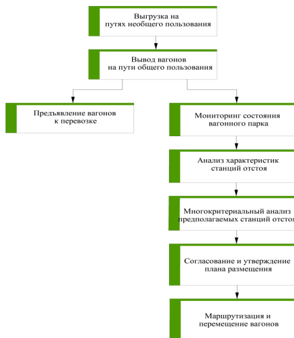
Рис. 4. Предлагаемый порядок работы с порожними вагонами после завершения грузовых операций
