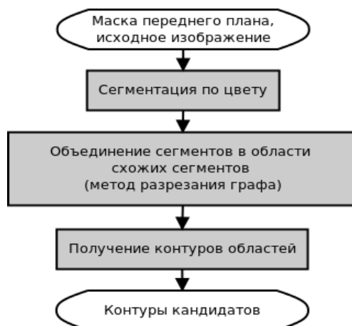
Рис. 2. Схема получения контуров объектов
