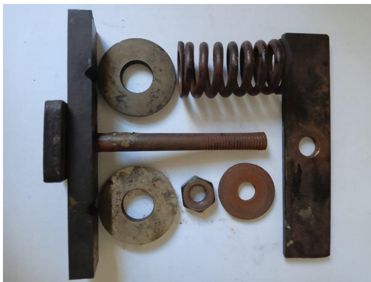
Рис. 2. Технологический пакет для нанесения покрытия на образцы
