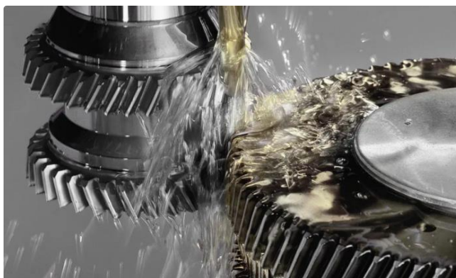
Рис. 1. Особенности обработки на зубодолбежном станке обкатного типа
