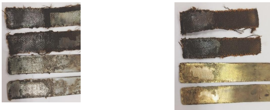
Рис. 4. Результаты разрушения адгезионного шва
