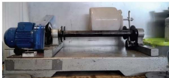
Рис. 4. Экспериментальная установка – барабанная мельница
