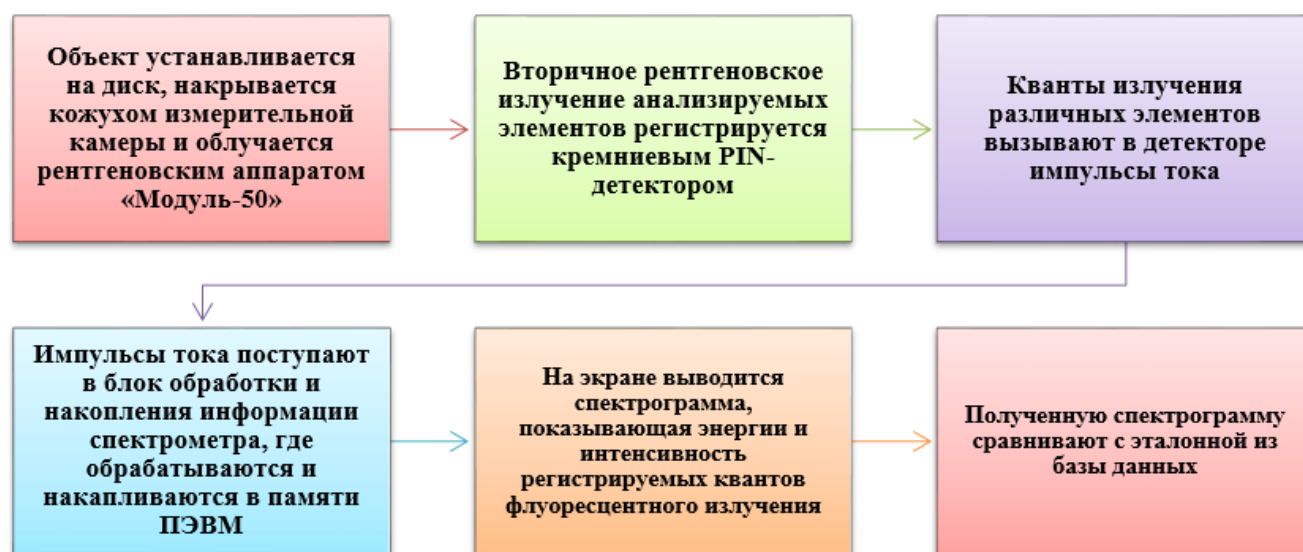
Рис. 4. Принцип работы прибора «ПРИМ-1РМ»
