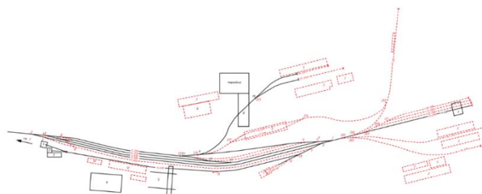
Рис. 2. Предлагаемая схема реконструкции пути необщего пользования (отмечено красными штриховыми линиями):
