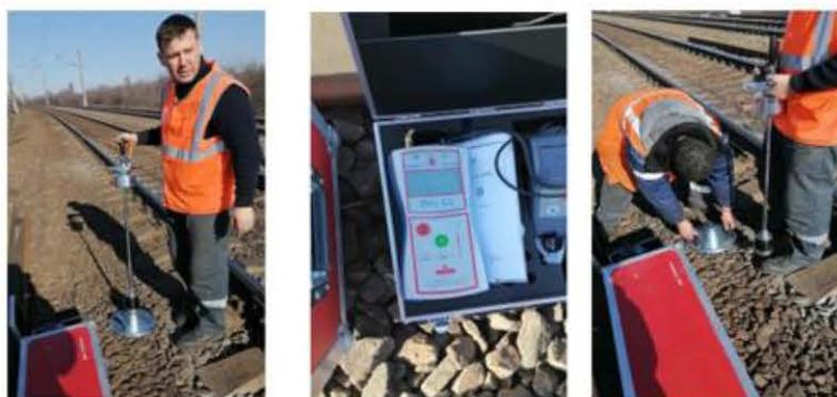
Рис. 6. Определение характеристики прочности и деформируемости балластного слоя
