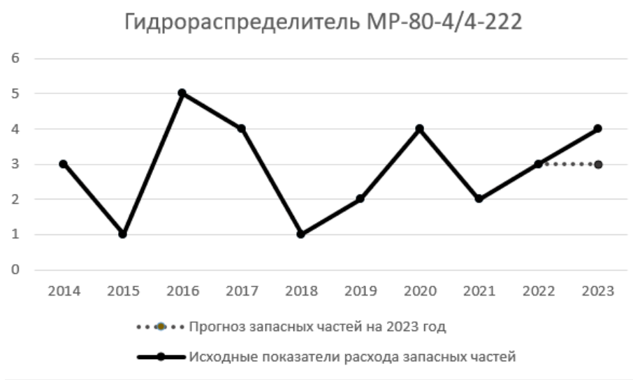
Рис. 5. График фактического расхода запчастей «Гидрораспределитель МР-80-4/4-222» для 2014–2023 гг. и прогноза на 2023 г.
