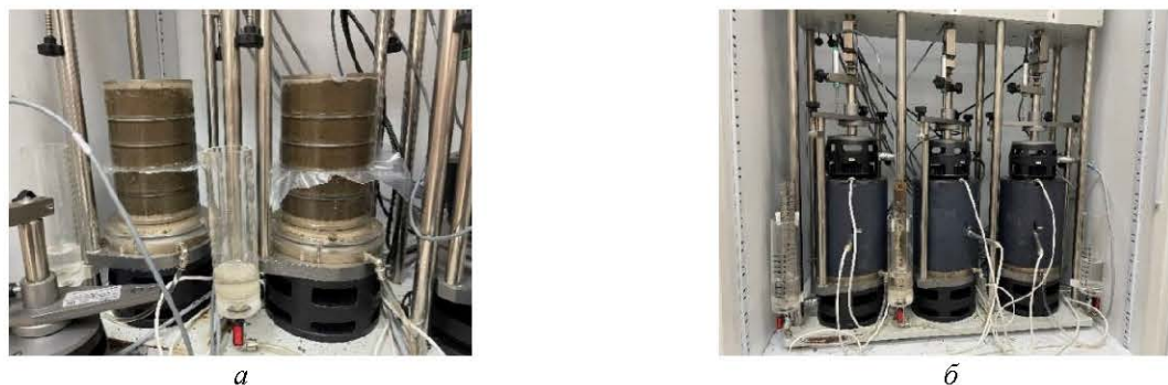
Рис. 4. Проведение лабораторного эксперимента: а – общий вид модели с капиллярным барьером; б – смонтированные блоки установки в момент проведения эксперимента
