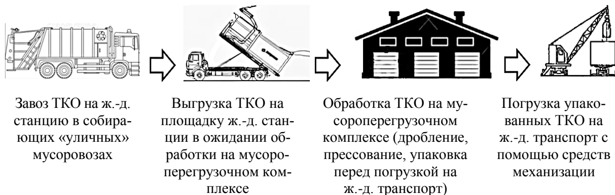
Рис. 2. Принципиальная схема погрузки ТКО на железнодорожный транспорт по варианту с обработкой на мусороперегрузочном комплексе
