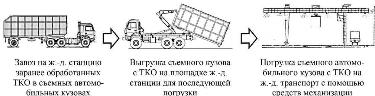
Рис. 1. Принципиальная схема погрузки ТКО на железнодорожный транспорт по прямому варианту «автомобиль – вагон»
