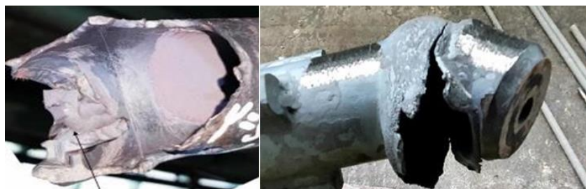
Рис. 2. Фото разрушенного впрыскивающего устройства
