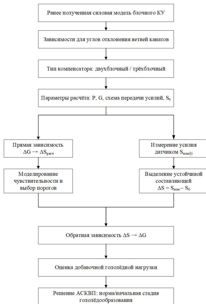
Рис. 1. Обобщённая структурная схема перехода от угловых зависимостей к расчётному ядру АСКВП
