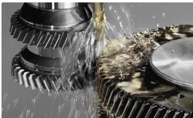
Рис. 1. Особенности обработки на зубодолбежном станке обкатного типа
