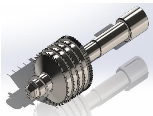
Рис. 2. Ротор вертикального измельчителя в сборе
