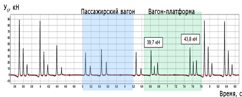
Рис. 7. Осциллограмма уровня боковых сил грузеной платформы и пассажирского вагона
