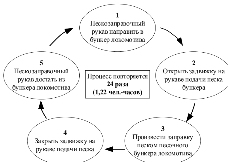
Рис. 1. Технологический процесс заправки электровоза серии 3ЭС5К песком при работе штатной системы пескоподачи
