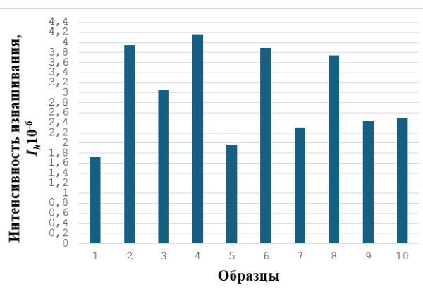
Рис. 3. Гистограмма интенсивности изнашивания образцов, сформированных в соответствии с планом эксперимента 2^3
