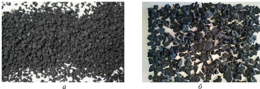
Рис. 1. Резиновая крошка, полученная в результате переработки с использованием вертикального рабочего органа:
