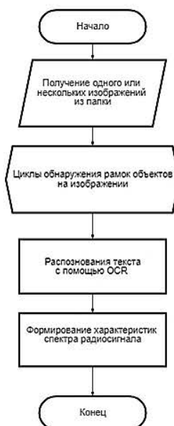
Рис. 8. Блок-схема алгоритма автоматического анализа характеристик спектра деструктивного воздействия
