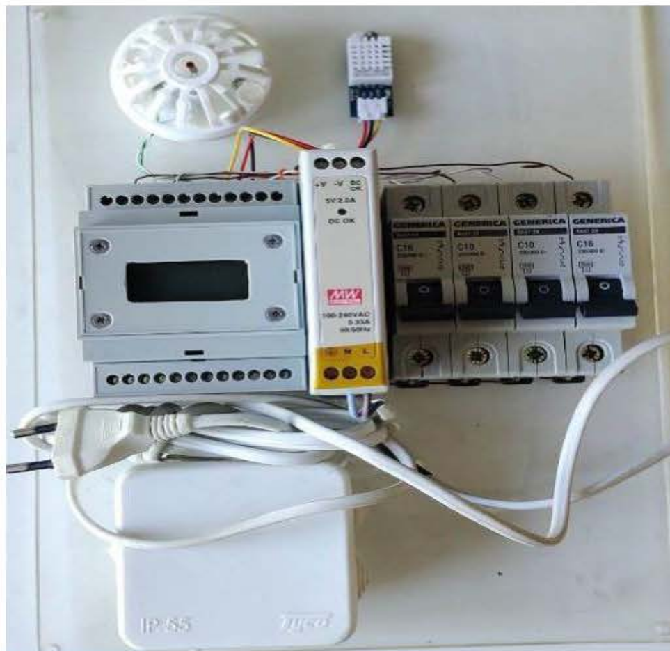
Рис. 5. Основные компоненты демонстрационного стенда управляющего автомата противоаварийной защиты технологических установок
