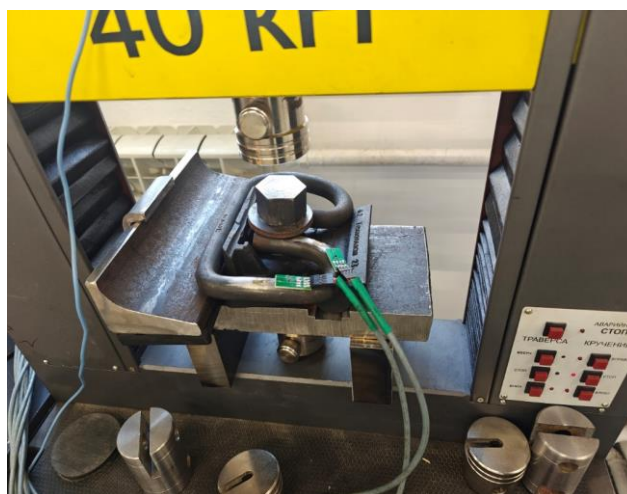
Рис. 3. Узел крепления с клеммой, оборудованной тензодатчиками, в рабочем поле машины МИ-40КУ
