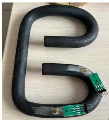
Рис. 4. Расположение тензодатчиков на упругой клемме скрепления ЖБР-65
