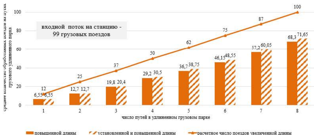
Рис. 8. Расчетные и фактические размеры пропущенных поездов через грузовой удлиненный парк в зависимости от числа путей при пропуске сниженного потока
