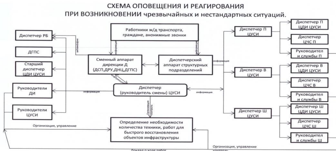
Рис. 2. Схема оповещения причастных при получении сигнала о возникновении ЧС на уровне регионального Центра управления содержанием инфраструктуры
