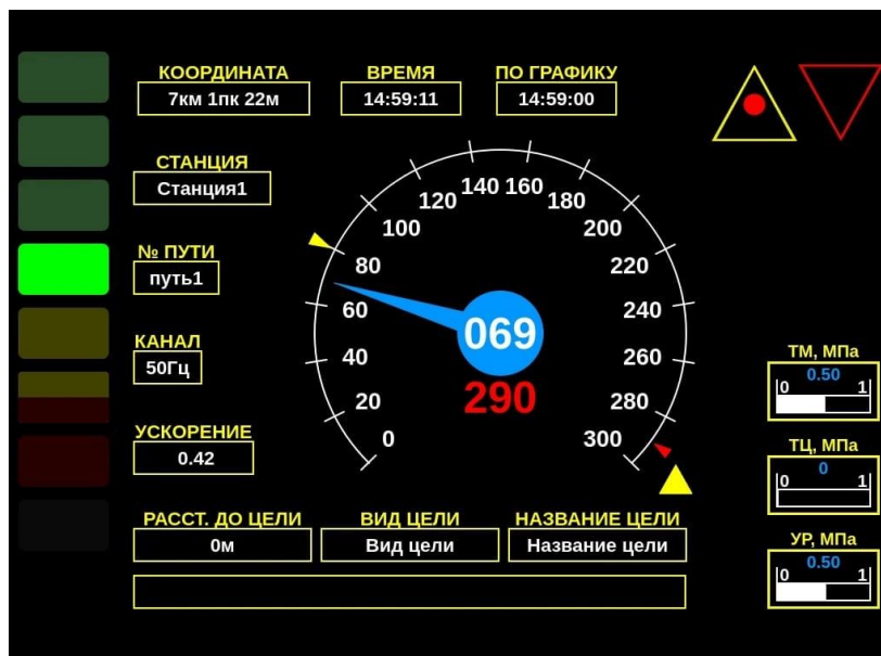
Рис. 5. Дисплейный модуль КЛУБ УЛТК «Сапсан» с сигнализацией АЛСН
