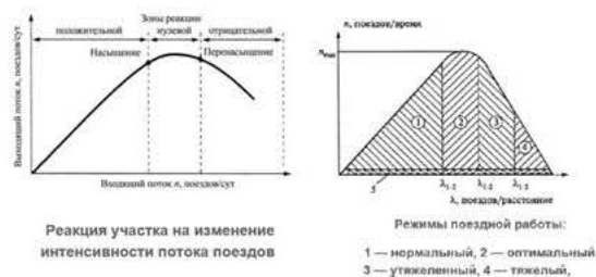
Рис. 2. Зависимость размеров движения от насыщенности участка поездами
