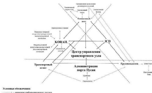
Рис. 2. Предлагаемая схема информационного взаимодействия в транспортном узле Пусан при наличии Центра управления транспортного узла
