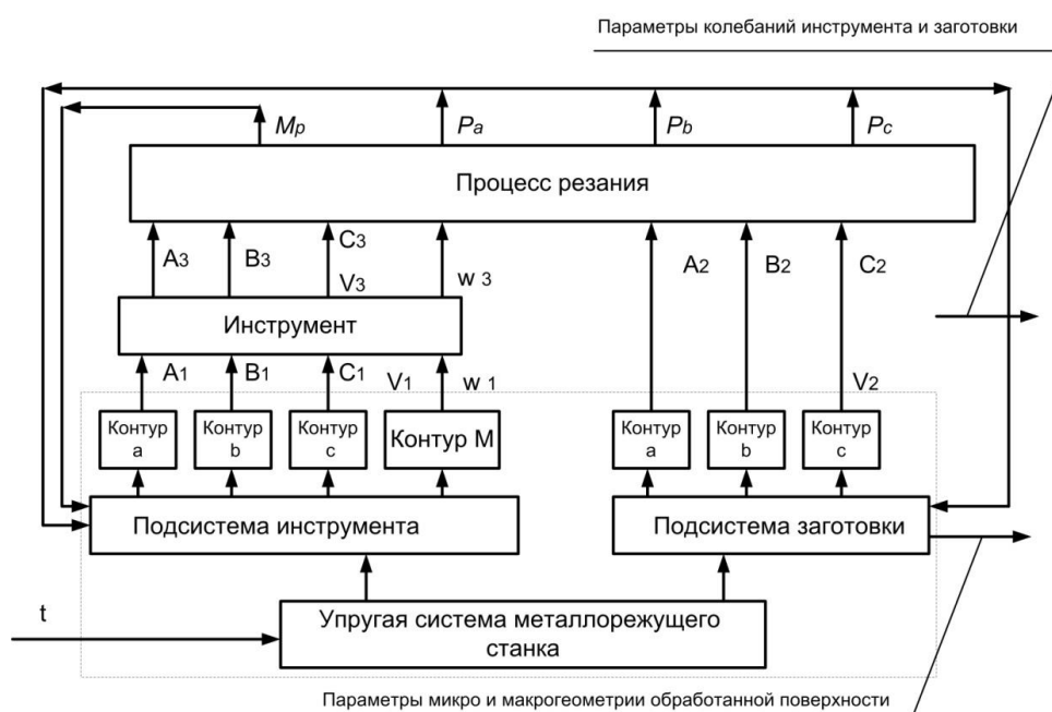
Рис. 1. Структурная схема динамической системы колесотокарного станка
